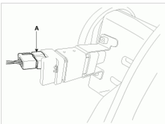
6. 检查1号端子和2号端子之间的导通性。如果不导通, 更换燃油加油口门开启执行器(A)。
