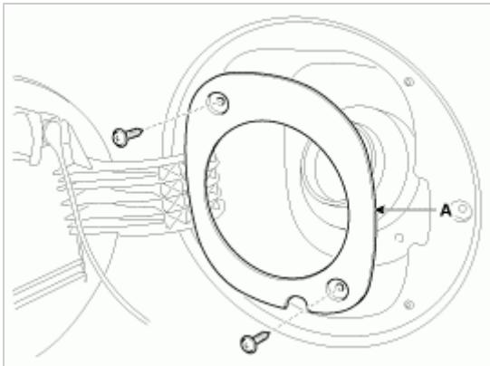
2. 拆卸燃油加油口门总成(A)。
